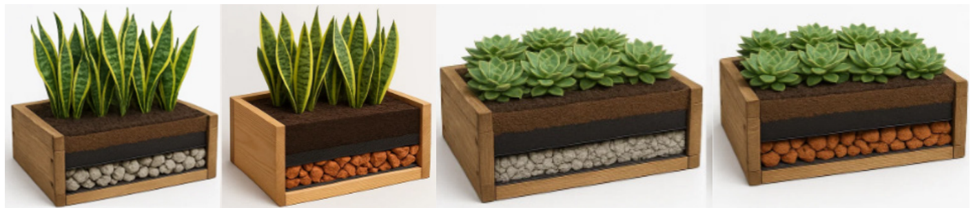
Figura 2. Vista del cajón-recipiente del modelo físico para alojar el sustrato del Techo Verde (Fuente: Elaboración propia).
