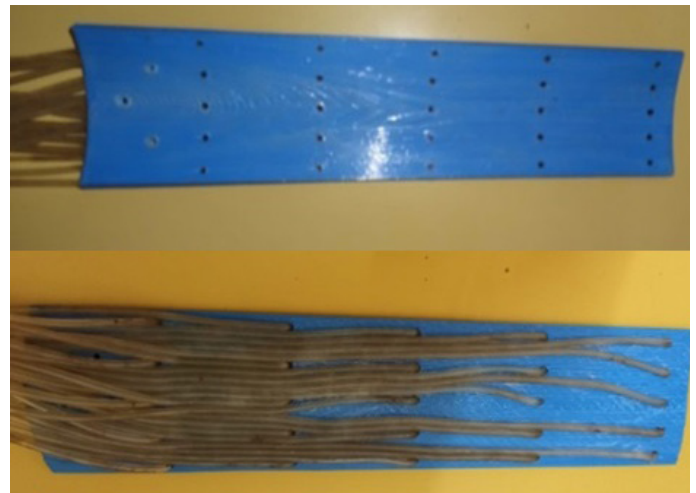
Figura 1. Modelo instrumentado con tomas de presión en el intradós y en el extradós
