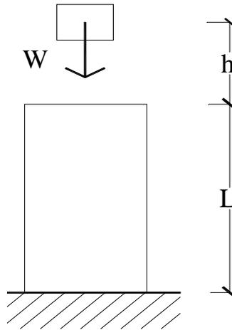
El trabajo realizado por la carga dinámica ( $W$ ) debe ser igual al trabajo realizado por una carga estática equivalente ( $P$ ) que produce la misma deformación  $\delta$  en la estructura que la carga dinámica.
