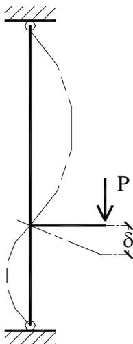
Se reemplaza la carga dinámica  $W$  por una carga estática  $P$  que produce la misma deformación  $\delta$  en el punto de aplicación, para ello hacemos:
